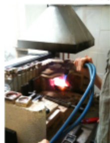
シルバーの粒と銅の粒を 溶かし地金を作る
